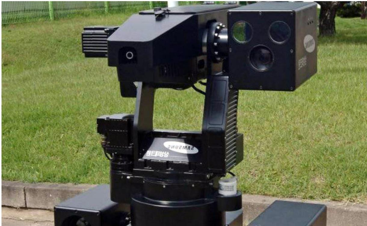
Le **Samsung SGR-A1** est un [robot militaire](#) sentinelle [sud-coréen](#) conçu pour remplacer les soldats humains dans la [zone coréenne démilitarisée](#) à la frontière avec la [Corée du Nord](#)<sup>1,2</sup>. C'est un système fixe, fabriqué par [Samsung Techwin \(en\)](#) (devenu Hanwha Techwin en 2016, puis [Hanwha Aerospace \(en\)](#) en 2018), filiale du [groupe Samsung](#).
